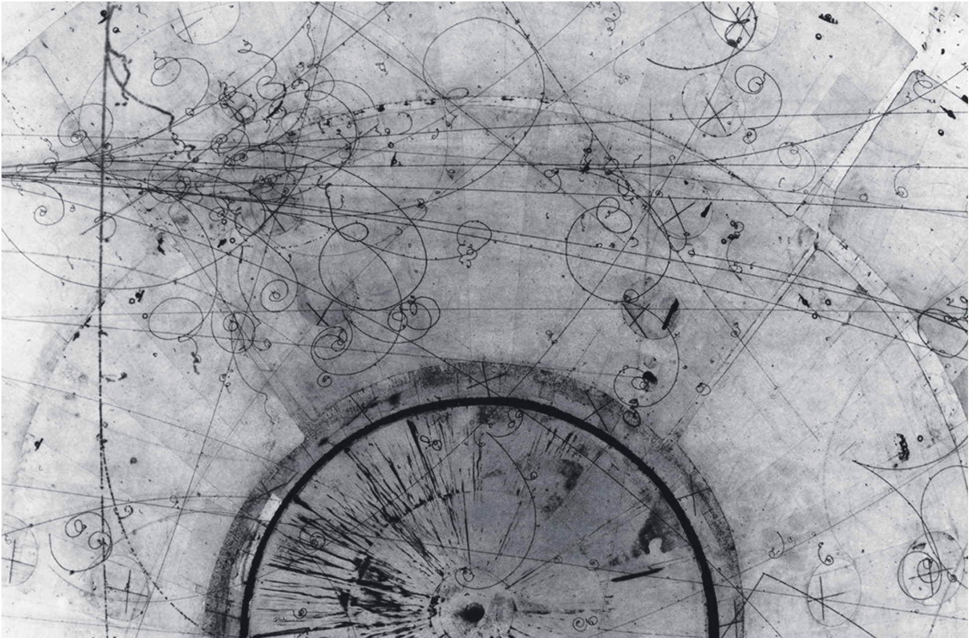
Traces laissées par des particules subatomiques, dessinant des arcs et des verticilles, après leur passage dans une chambre à bulles du Fermi National, Accelerator Laboratory © Fermilab, Chicago, 1978
